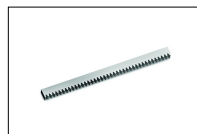
GA550 Crémaillère en acier 22x22x1000 galvanisé module 4.
